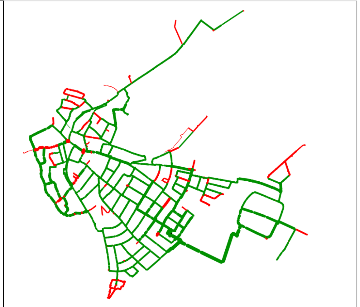
Stagnation ohne Feuerlöschleitung
