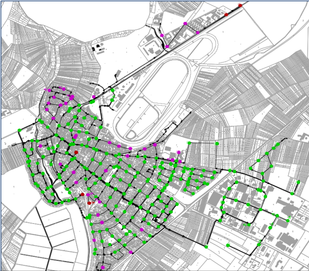
LW-Bereitstellung mit Feuerlöschleitung
