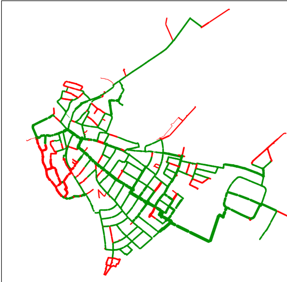
Stagnation mit Feuerlöschleitung
